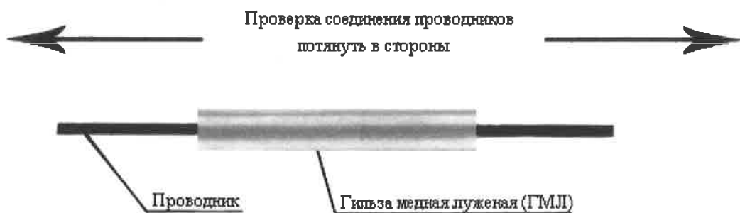
Рисунок 2 – Проверка соединения проводников на прочность обжима
